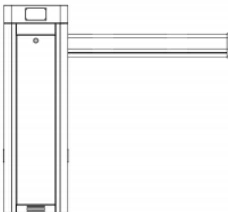
L: Gabinete instalado de lado Izquierdo. El mástil baja hacia el lado derecho
